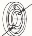
Mettre la roue en place et insérer l'essieu par le côté magnéto. Visser l'essieu de quelques tours. S'assurer que le guide du plateau de frein est dans sa rainure.
