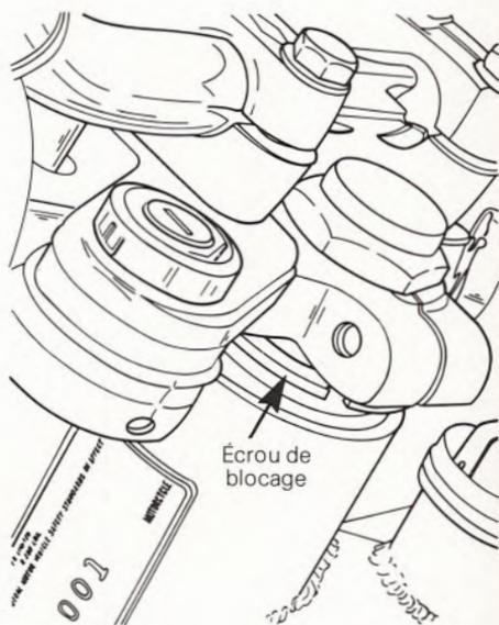
Enfoncer la couronne du haut sur l'écrou fendu, puis enduire les filets de l'écrou de l'axe de fourche de "Loctite Lock'n Seal" et serrer à 12-14 kg-m (90-100 lb-pi). Serrer la vis de blocage de l'axe de fourche à .8-1.1 kg-m (6-8 lb-pi). Serrer les vis des brides de fourche à 1.4-1.5 kg-m (10-11 lb-pi).
