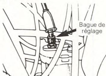
Tourner la bague de réglage de la pompe à huile jusqu'à ce que les marques repères soient alignées.
