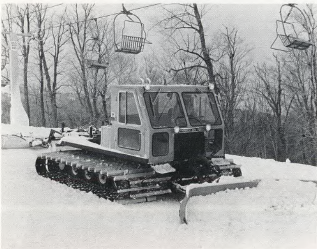
Lame extra-robuste en U avec contrôles 6 directions.
