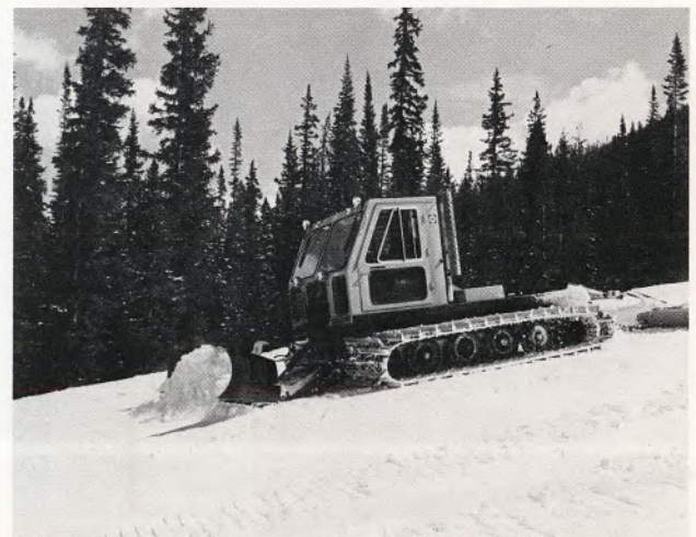
Modèle au diesel. Grande performance à haute altitude. Tablier arrière pour installer de l'équipement.
